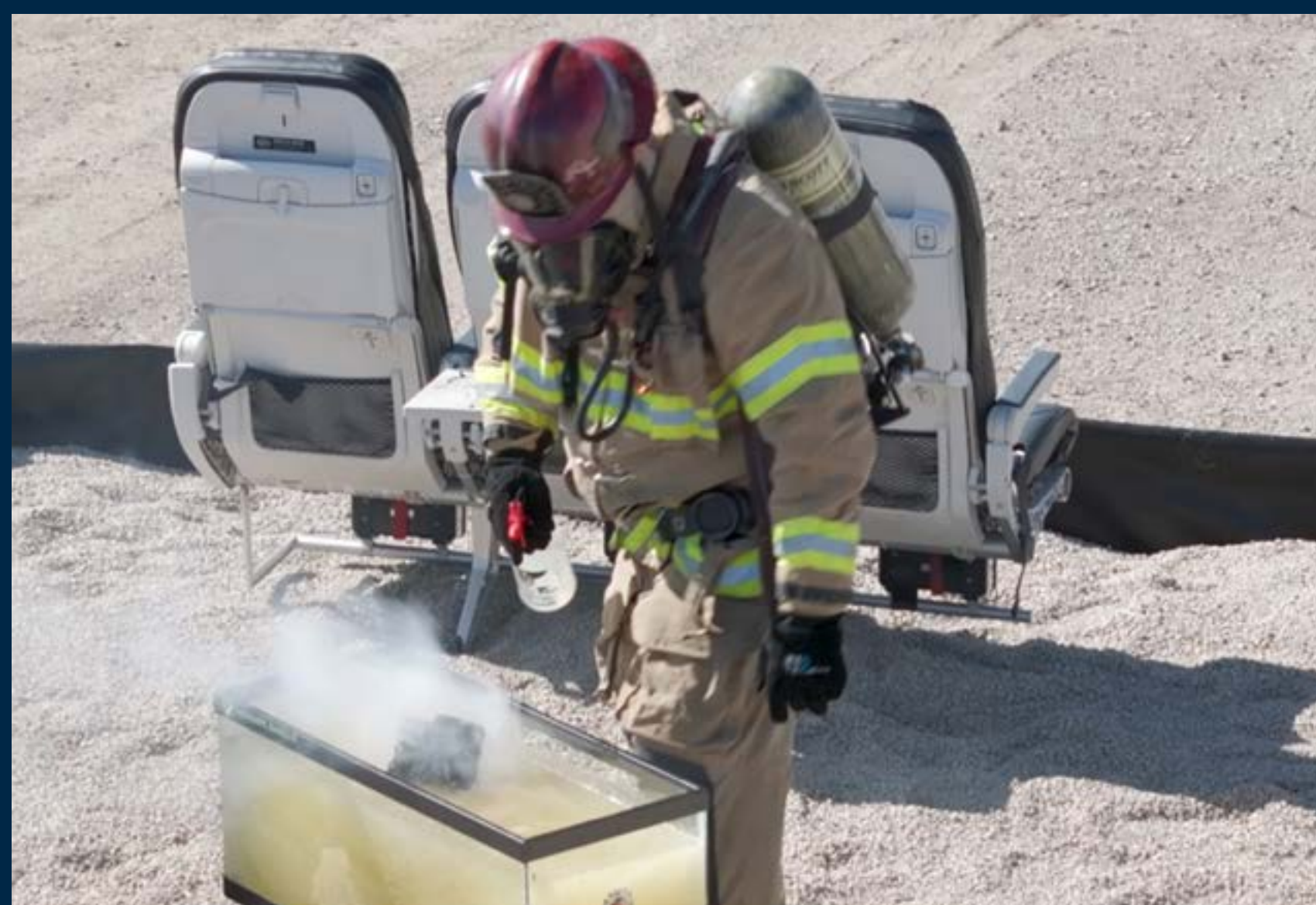
Brennende bærbar datamaskin - litium-ion-batteri med termisk rømning under simulert flydemonstrasjon.
