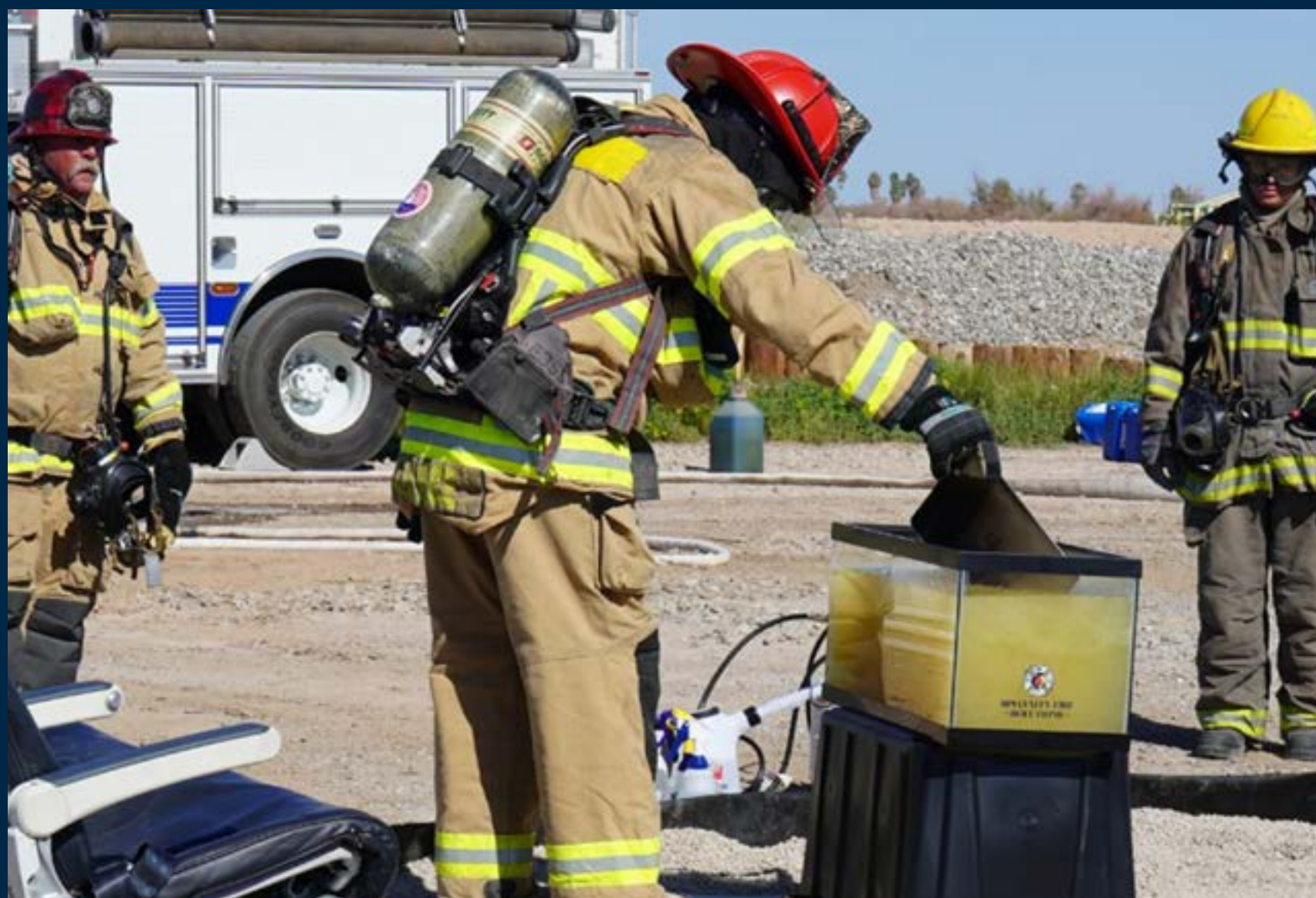
Brennende bærbar datamaskin - litium-ion-batteri med termisk rømning nedsenket under produkttesting.
